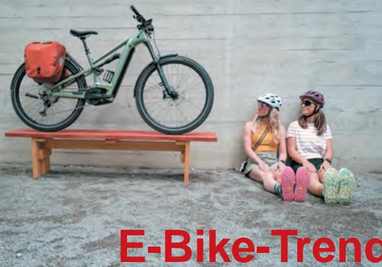
Um für möglichst lange Touren gerüstet zu sein, kommt ein großer Akku, meist ins Unterrohr integriert, zusammen mit einem leistungs- und drehmomentstarken Motor zum Einsatz.
