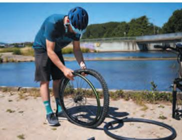
leicht aufpumpen, gelingt das viel leichter und er kann im nächsten Schritt nicht einklemmen. Ziehen Sie im Anschluss die zweite Seite des Reifens so weit wie möglich mit der Hand in die Felge! Kontrollieren Sie nun, ob der Reifen mit beiden
