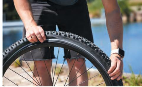
Wülsten möglichst mittig, also tief in der Felge liegt - so haben Sie den größten Spielraum für den letzten Schritt: Versuchen Sie mit etwas Kraft, die letzten Zentimeter des Reifens über das Felgenhorn zu heben. Sollte es per Hand nicht funktionieren, können Sie auch den Reifensheber zur Unterstützung nutzen. Stellen Sie hierbei aber unbedingt sicher, dass Sie den Schlauch nicht beschädigen!
