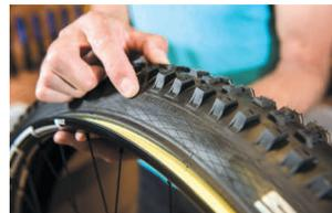
Als nächstes setzt man den Reifen zunächst mit einer Wulst auf die Felge. Hierbei ist zwingend auf die richtige Laufrichtung des Reifens zu achten. Ästhetiker sorgen für die gleiche Position der Reifenbeschriftung zum Ventil.
