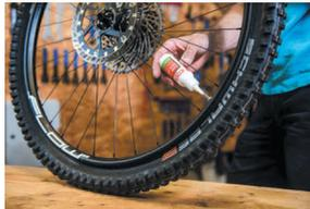
Über die spitze Kappe der kleinen Flasche wird die Dichtmilch durch den offenen Ventilschaft in den Reifen eingefüllt.
