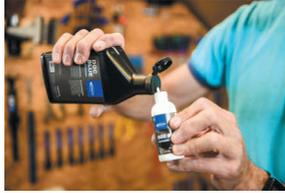
Einfach dosieren lässt sich die Dichtmilch mittels der kleinen 60-Milliliter-Fläschchen. Bei der Erstmontage vertragen breite Mountainbike-Reifen wie in unserem Beispiel durchaus 100 Milliliter der Dichtflüssigkeit, während schmalere Rennradreifen mit einer Flaschenfüllung auskommen.
