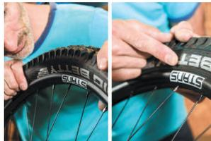
Um den richtigen Sitz des Reifens zu kontrollieren, inspiert man beidseitig den Übergang von Felge und Reifen: Rechts zeigt der gleichmäßig sichtbare Kontrollstreifen den richtigen Sitz des Reifens an.
