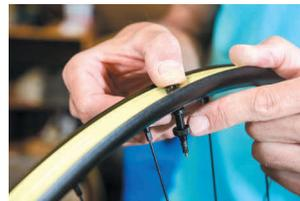
Mit dem Tubeless-Ventil wird das Felgenband am Ventilloch vorsichtig durchstochen. Eine Rändelmutter mit Dichtungsring sorgt für den sicheren und luftdichten Sitz des Ventils.
