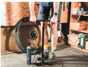
Damit der Tubeless-Reifen sich aus dem Felgenbett perfekt passend an die Felgenflanken setzen kann, braucht es für gewöhnlich einen kräftigen Luftstoß. Diesen liefert entweder ein Kompressor, eine spezielle Tubeless-Pumpe mit eigenem Hochdruckreservoir - oder, wie hier im Bild, eine externe Hochdruckkammer wie der "Tire Booster" von Schwalbe. Mit einer herkömmlichen Standpumpe lässt sich der Booster auf zwölf Bar aufpumpen und gibt die Luft stoßartig ab.
