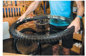
der Reifen wieder aufgepumpt. Nungiltes, die Flüssigkeit gleichmäßig im Reifen zu verteilen. Dazu schüttelt man die hörbar plätschernde Dichtmilch einmal rundum an jede Position des Rads. Das Ventil dient hierbei als Orientierungspunkt.
