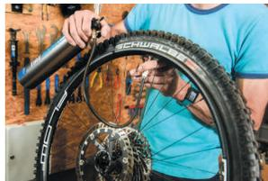
Durch Öffnen des Ablassventils entlädt sich die Hochdruckkammer rapide in den Reifen. Durch den Luftdruck werden die Reifenwulste nach außen gedrückt und setzen sich meist mit zwei- bis viermaligem lauten Knacken in die Felgenflanken.
