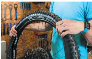
Jetzt wird die zweite Reifenwulst ins Felgenbett gehoben. Am einfachsten geht das, wenn sich beide Reifenwulste in der vertieften Mitte des Felgenbetts treffen.
