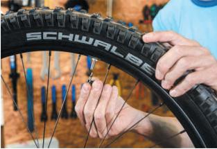
Mithilfe eines Ventilschlüssels lässt sich der Ventileinsatz aus dem Ventilschaft entnehmen. Hierfür ist der feste Sitz des Schafts in der Felge nötig bzw. oft das Gegen-
