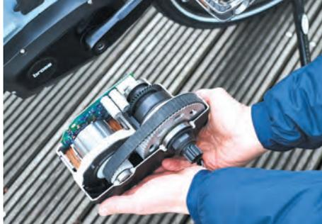
Bei der Entwicklung von Carbonriemen für Fahrräder und E-Bikes spielen diese Erfahrungen aus anderen Bereichen selbstverständlich eine Rolle. Allerdings sind die Fahrradriemen ein komplett eigenes Produkt: Riemenstärke und -breite sowie das Zahnprofil auf der Innenseite sind speziell auf den Einsatz am Fahrrad abgestimmt. "Es ist falsch anzunehmen, dass es einen Riemen für alles gibt. Die Riemen unterscheiden sich je nach Einsatzzweck. Die Entwicklung und Produktion ist ein sehr
