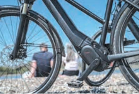
An immer mehr E-Bikes wird mittlerweile der im Rahmen verbaute Akku genutzt. “Der Vorteil sticht auf den ersten Blick ins Auge: Der Akku ist optisch sauber in den Rahmen integriert und fügt sich stimmig ins E-Bike ein. Oder anders gesagt: Man sieht nicht mehr sofort, dass es sich um ein E-Bike handelt”, erklärt Anja Knaus vom E-Bike-Hersteller Flyer. Durch den Sitz im Unterrohr ist er zudem besser vor Nässe und
